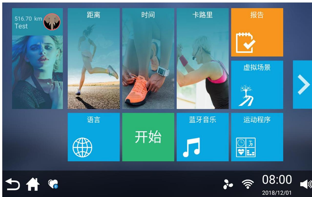
2. 开启蓝牙，点击 “ ” 可出现刷新蓝牙列表，同时打开手机蓝牙设备就可以检测到设备名：BT-Speaker 设备了，连接配对成功即可播放音乐。
